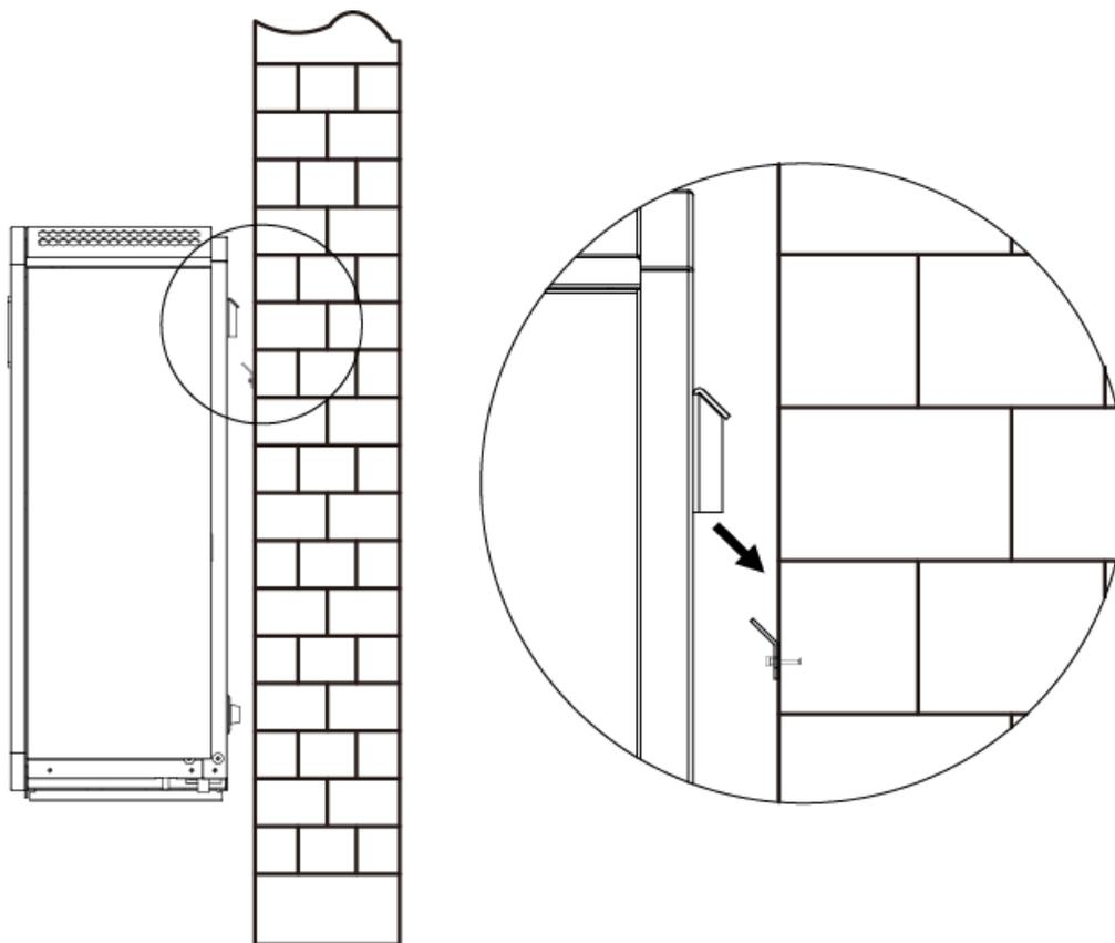
**Подвесив оборудование на кронштейн осторожно опускайте его до тех пор, пока наклейки снизу не упрутся в стену.**
