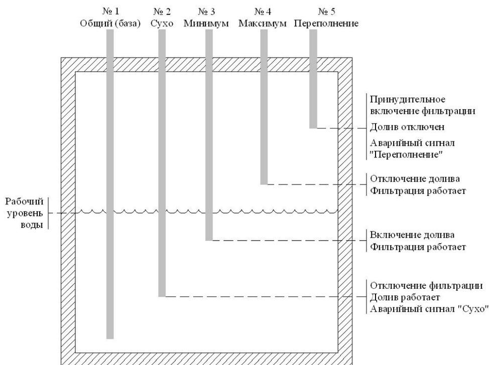
Для бассейна **скиммерного типа**, используются клеммы: №№ 1,2,3 в зависимости от заданного в пункте **6.4.6.8.** типа используемого датчика уровня воды.
