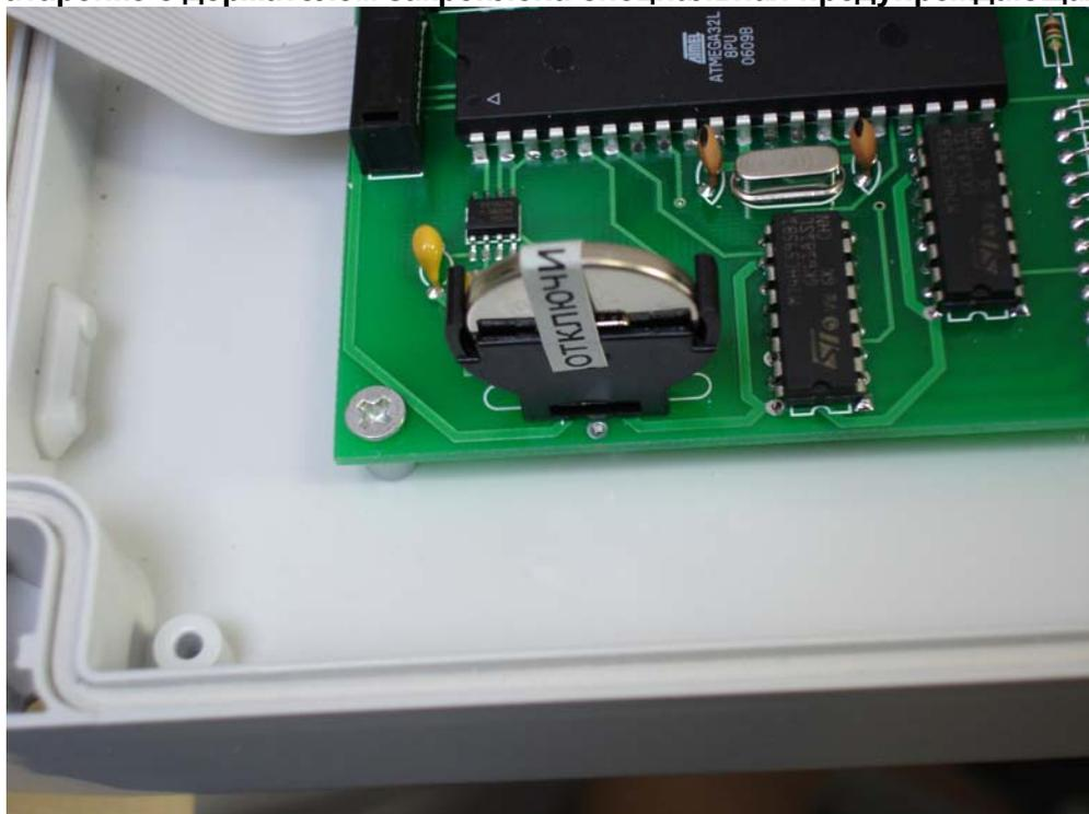
Замена батарейки, в случае её разрядки, также должна осуществляться при отключенном сетевом питании. Разряженная батарейка не позволяет запускаться микропроцессору прибора (на дисплее нет индикации). В этом случае отключите питание, удалите из держателя батарейку, включите сетевое питание прибора. Если индикация появилась, необходимо произвести замену батарейки.
