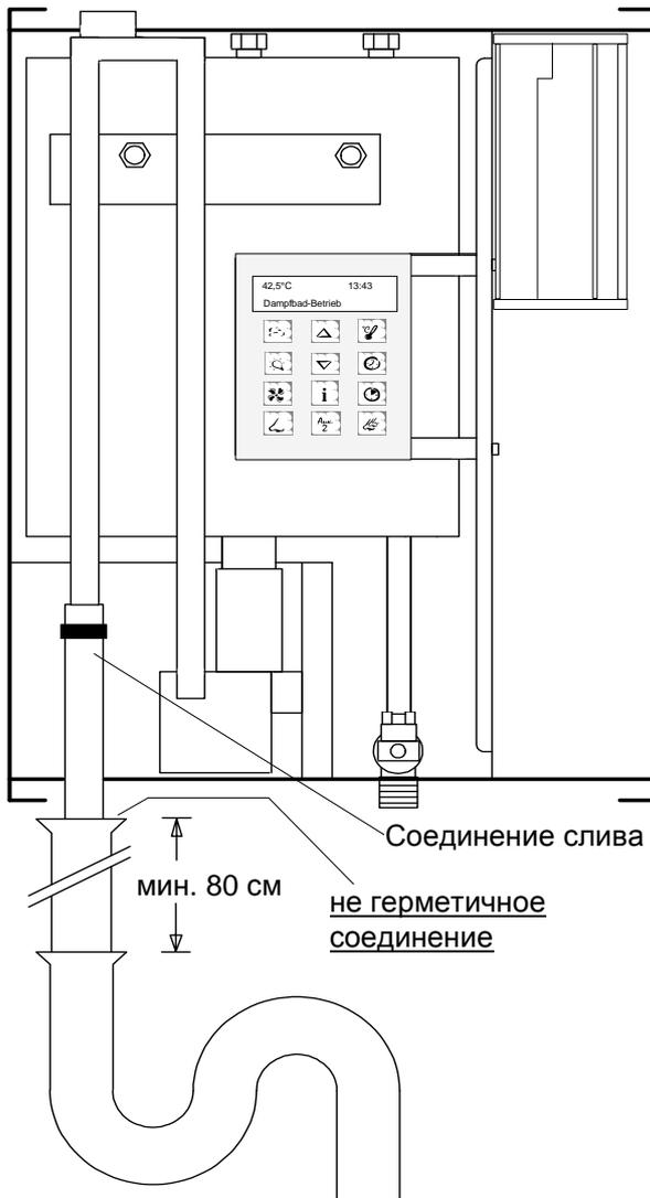
Слив присоединяется с помощью гибкого шланга к левой трубке парогенератора (см. рис.). Соединение закрепляется с помощью хомута. Гибким шлангом осуществляется соединение с канализационной системой.
