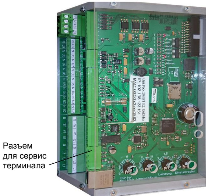
Для оптимальной адаптации парогенератора к различным кабинам, а также для облегчения ввода в эксплуатацию и последующего обслуживания можно к блоку управления подключать osf-Service-Terminal (Арт. N.3010000900). Соответствующий разъем находится на верхней плате электронного блока
