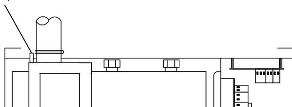
В верхней части левой трубки из нержавеющей стали, находится отверстие (см. рис.), которое обязательно необходимо для вентиляции системы. Это отверстие ни в коем случае нельзя закрывать. Закупорка этого отверстия неизбежно приведет к сбою в работе устройства. Если во время работы парогенератора из отверстия выплескивается вода, то это означает недостаточную проходимость слива или он забит.
