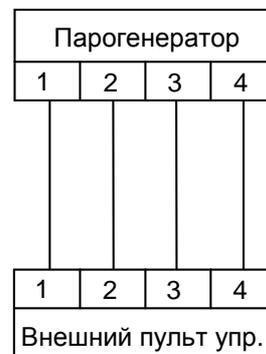
**Длина соединяющего кабеля не должна превышать 50 метров.** Избегать прокладку кабеля вблизи с силовыми кабелями из-за возможных наводящихся помех. Внешнюю панель не разрешено устанавливать внутри паровой кабины.
