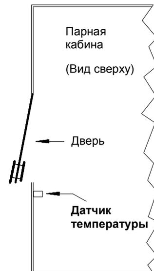
Для нормальной работы парогенератора обязательно необходимо, чтобы оба провода датчика температуры были присоединены к соответствующим клеммам парогенератора. Дефектный, не присоединенный или закороченный датчик температуры приводит к немедленному срабатыванию защиты и соответственно к прекращению производства пара. Для возможной проверки работоспособности датчика используйте рядом расположенную таблицу.
