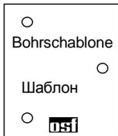
При установке парогенератора рекомендуется применять шаблон, входящий в поставку парогенератора, на котором размечены необходимые для монтажа отверстия. Закреплять парогенератор разрешается только на достаточно прочной основе. Размещать парогенератор SILVER-STEAM в соответствии с его нормами необходимо во влагозащищенном месте.
