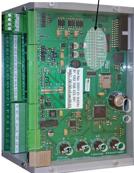
Электронный блок управления содержит некоторое количество индикаторов, с помощью которых можно контролировать работу некоторых компонентов системы
