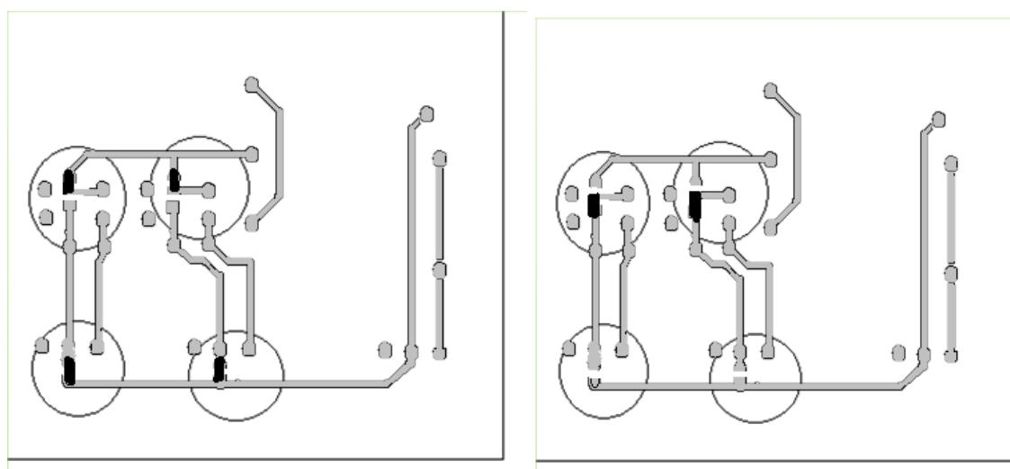
В выделенных окружностями зонах части монтажной платы прибора, изготовленителем (по умолчанию рис. А) выполнено соединение печатных проводников для фазного «L» управления подключаемого оборудования.
