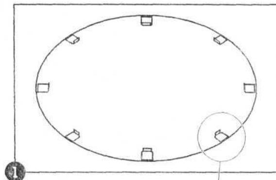
б. Вставьте загнутые рейки нижних направляющих в кронштейны основания каркаса и сдвиньте. Между концами соседних реек необходимо оставить зазор шириной  $\frac{1}{4}$ " (13 мм).
