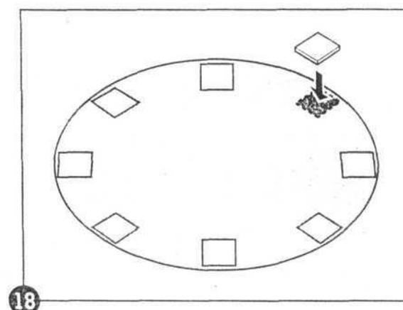
г. Камни необходимо утопить в землю так, чтобы их верхняя плоскость располагалась вровень с поверхностью земли. Используйте столярный уровень, чтобы удостовериться в соответствии уровня камней и земли. Чтобы выровнять уровень камней друг относительно друга, следует также использовать планку и столярный уровень.
