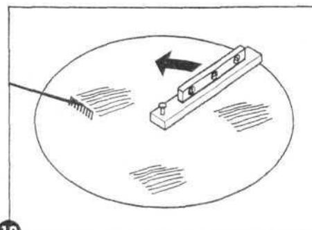
д. **Не подсыпайте** для выравнивания свежий грунт. Это ослабляет безопасность фундамента бассейна. Допускается заполнение небольших ямок и впадин, но после этого земля **должна быть** сильно утрамбована при помощи инструмента для трамбовки.
