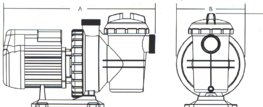
Для подсоединения насоса предусмотрен разъемные муфты с внутренним диаметром 50 мм. для клеевого соединения.
