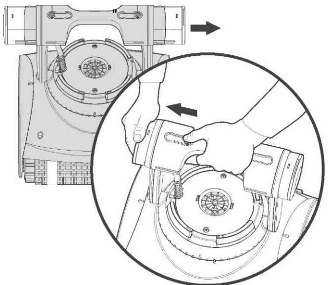
Нажмите кнопки на каждом поплавке и вытяните поплавки, удерживая кнопки нажатыми.
