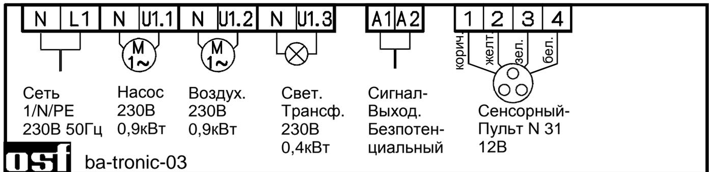
Безпотенциальный контакт «Сигнал выход.» всегда замкнут, если включен гидромассажный насос или воздуходувка. Питание для подводного прожектора необходимо подводить через отдельно установленный трансформатор с безопасным напряжением.
