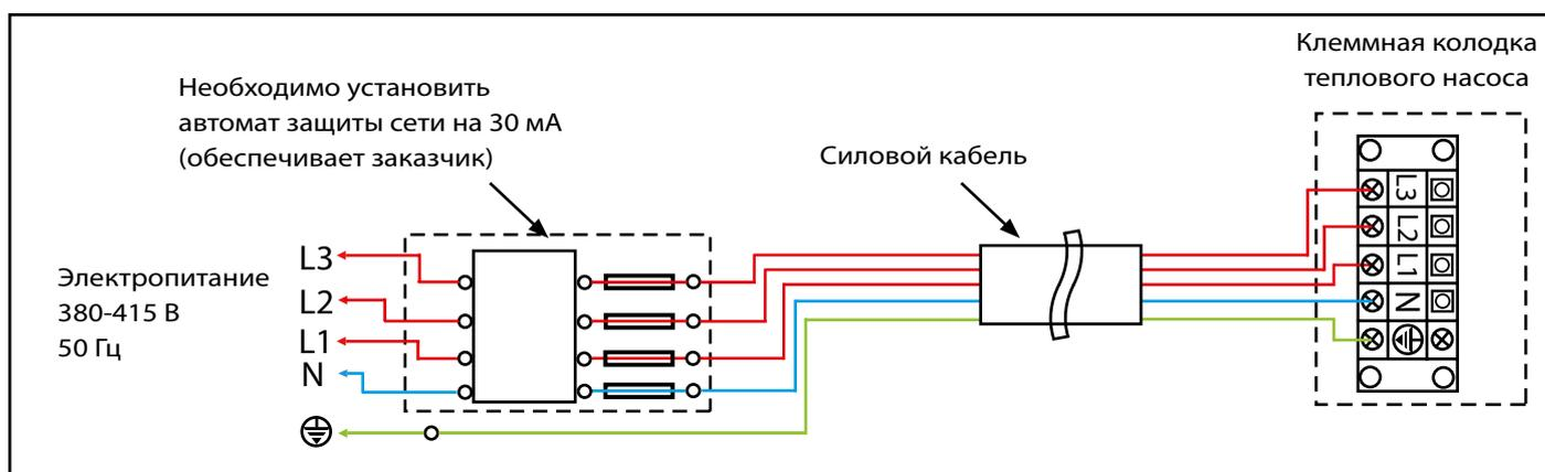
Примечание: Тепловой насос должен быть заземлен надлежащим образом.
