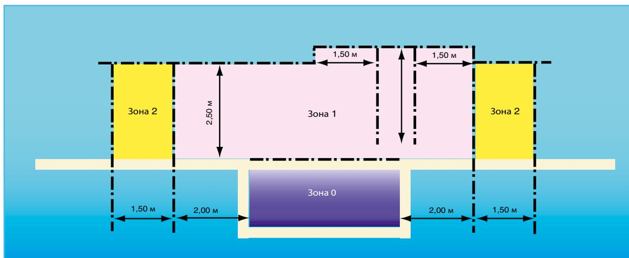
Зона 0: Безопасное сверхнизкое напряжение\* (SELV) < 12 В переменного тока или 30 В постоянного тока + оборудование со степенью защиты IPX8 (пылезащищенное, водостойкое).
