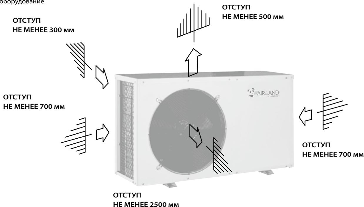
Выходящий из теплового насоса воздух не должен попадать в него обратно, даже частично, поэтому тепловой насос не следует устанавливать в месте, ограниченном стенами, даже при соблюдении минимально допустимых отступов.
