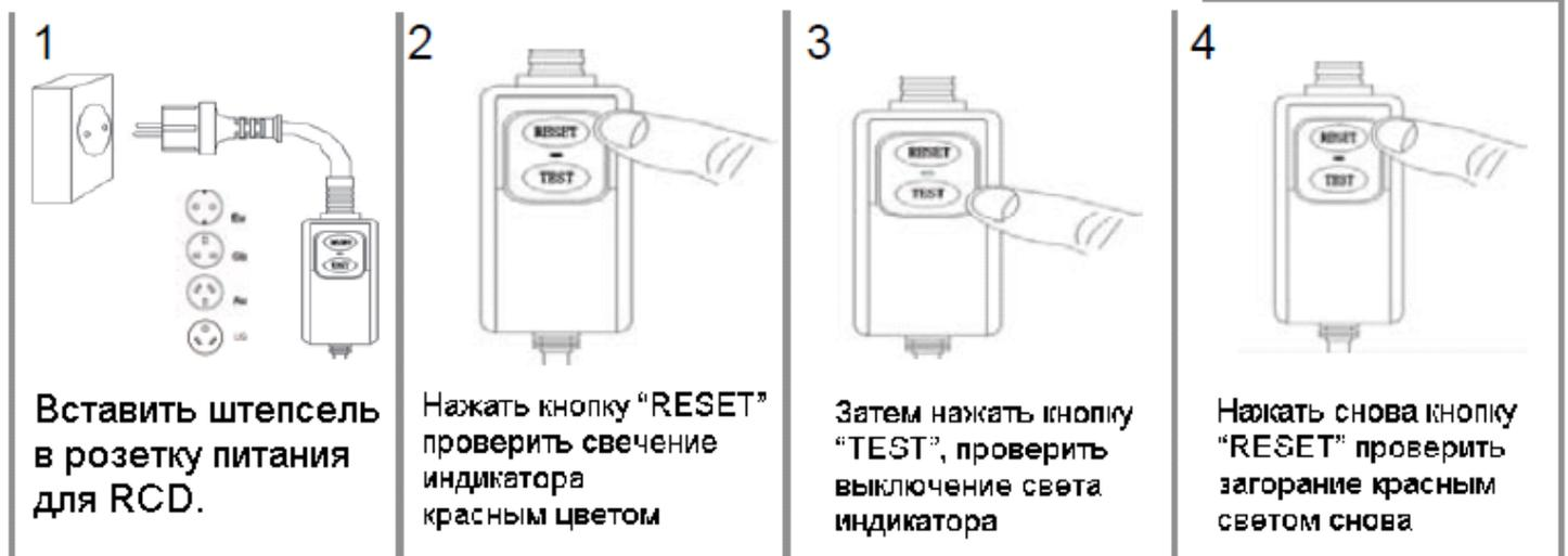
Если все вышеупомянутые шаги успешны, насос SPA готов к работе. Примечание: штепсель может быть заменен другим соответствующим стандартам безопасности. Имеются три возможно близких варианта “со штепселем, со штепселем RCD или штепселем GFCI или без штепселя”. Обратитесь к квалифицированным электрикам, если нет штепселя для вашего насоса.
