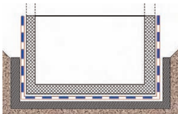
Конструкции в гидроизоляционных ваннах
