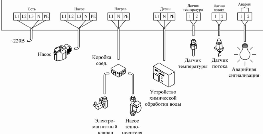
**Подключение насоса и других нагрузок, МОЩНОСТЬ КОТОРЫХ ПРЕВЫШАЕТ 2кВт, производится ТОЛЬКО ЧЕРЕЗ ДОПОЛНИТЕЛЬНЫЕ ЭЛЕКТРОМАГНИТНЫЕ ПУСКАТЕЛИ!**
