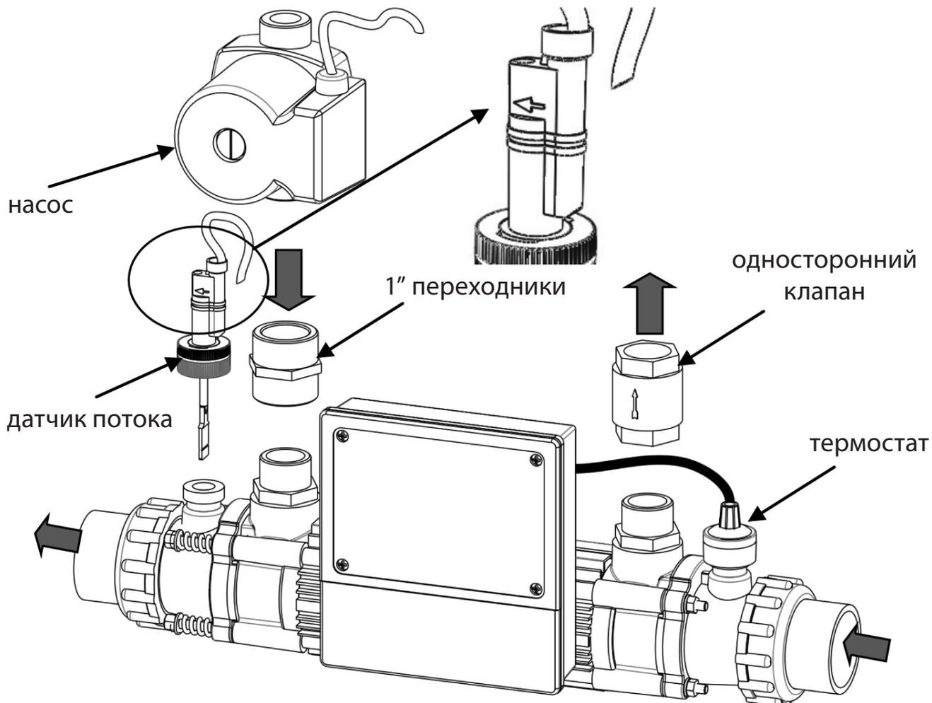
Контрольный блок может быть прикреплен к теплообменнику как показано на диаграмме с помощью поставляющегося крепежа.
