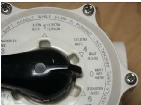
При консервации фильтровальной установки, для предотвращения деформаций, растрескивания прокладки переключения режимов (см. рисунок 4 поз.8), ручку вентиля необходимо перевести в положение «0». В режиме зимней консервации положение ручки вентиля показано на рисунке 11.
